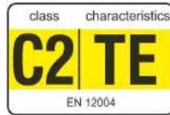
CIMENT-COLLE AMÉLIORÉ À TEMPS OUVERT ALLONGÉ, SANS GLISSEMENT, POUR LE COLLAGE DE CARREAUX EN CÉRAMIQUE, CLINKER, GRÈS, TERRE CUITE, DE GRANDES ET MOYENNES DIMENSIONS, POUR L'INTÉRIEUR ET L'EXTÉRIEUR, POUR DES ÉPAISSEURS D'APPLICATION JUSQU'À 15MM
